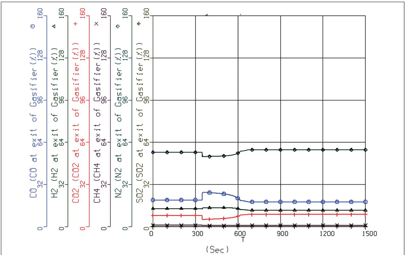
FIG. 2.3 SYNGAS COMPOSITION AT GASIFIER OUTLET.
