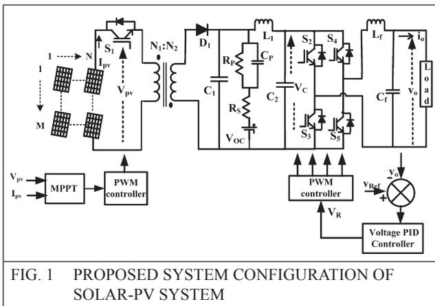
FIG. 1 PROPOSED SYSTEM CONFIGURATION OF SOLAR-PV SYSTEM
