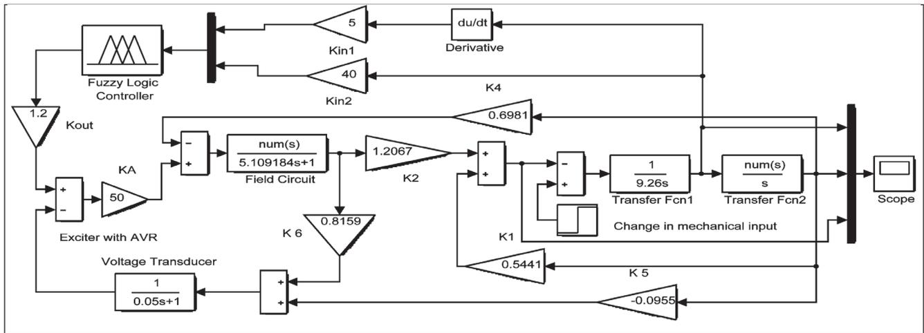
FIG. 6 SIMULINK MODEL WITH FLPSS CONTROLLER
