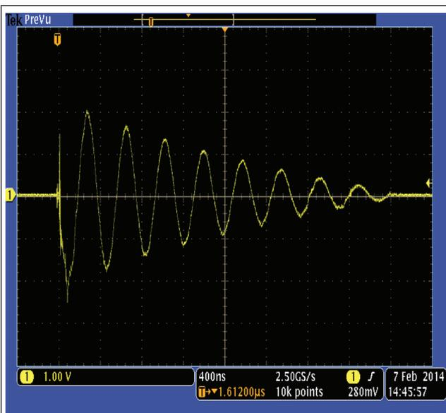
FIG. 3 (B) DISCHARGE WAVEFORM OF 10NF, 20KV CAPACITOR
