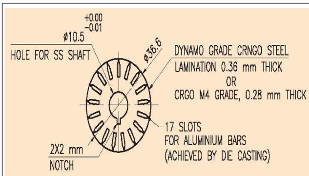
FIG. 2 CROSS SECTIONAL VIEW ROTOR
