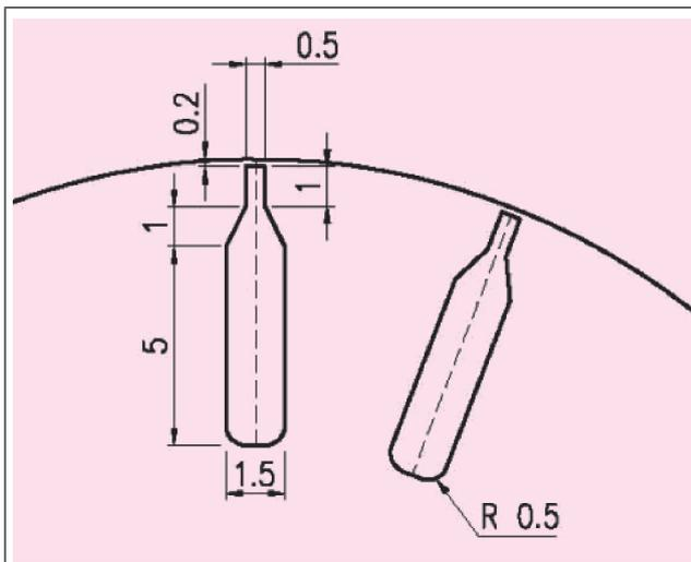
FIG. 3 CROSS SECTIONAL VIEW ROTOR SLOT
