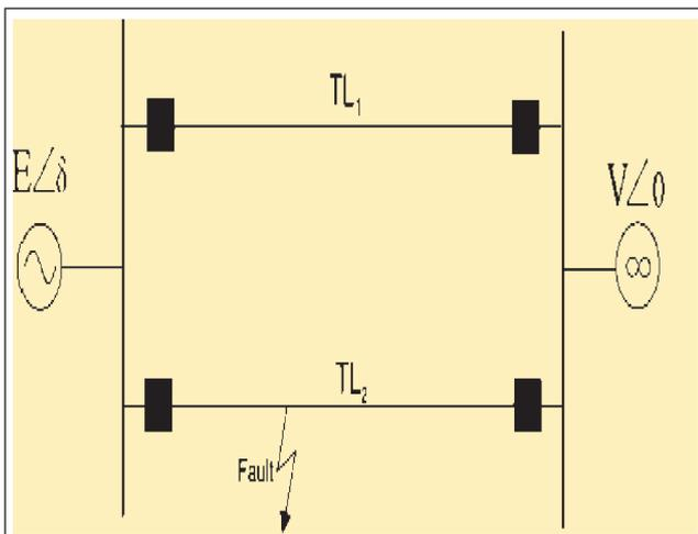
FIG. 1 SINGLE MACHINE INFINITE BUS SYSTEM
