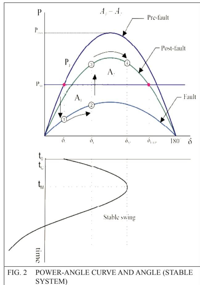
FIG. 2 POWER-ANGLE CURVE AND ANGLE (STABLE SYSTEM)
