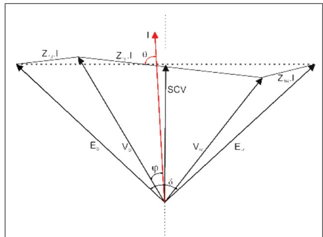
FIG. 9 POWER-ANGLE CURVE AND ANGLE (STABLE SYSTEM)
