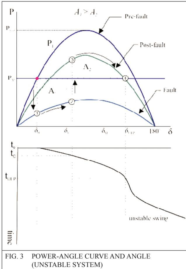
FIG. 3 POWER-ANGLE CURVE AND ANGLE (UNSTABLE SYSTEM)
