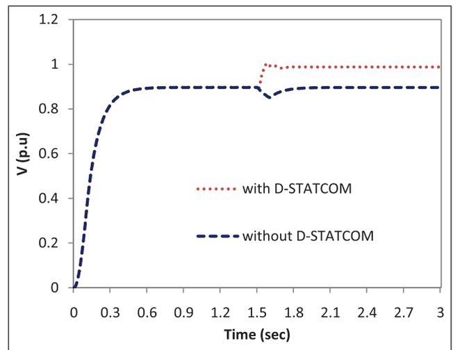
FIG. 6 SINGLE PHASE-TO-GROUND FAULT
