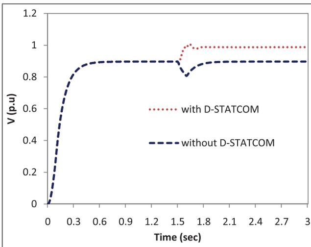
FIG. 5. 2 PHASE-TO-GROUND FAULT
