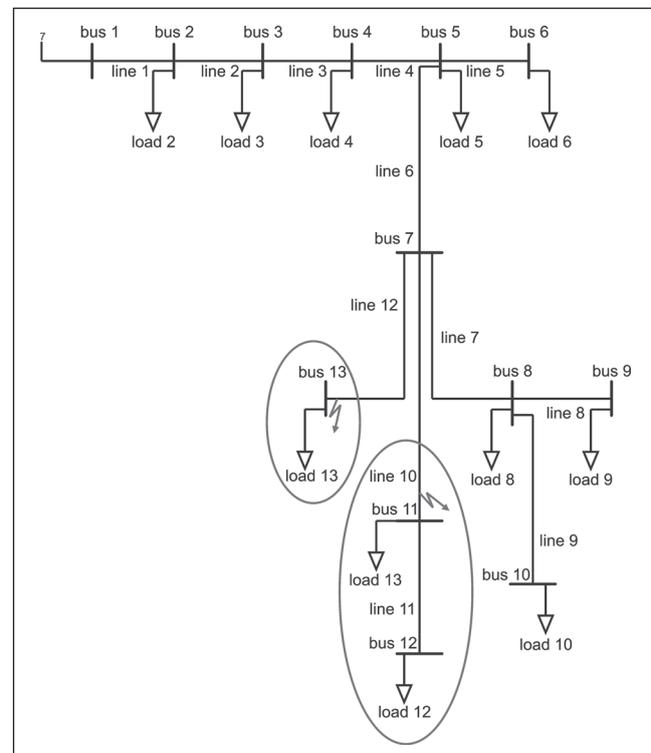
FIG. 1 13 BUS RADIAL DISTRIBUTION SYSTEM
