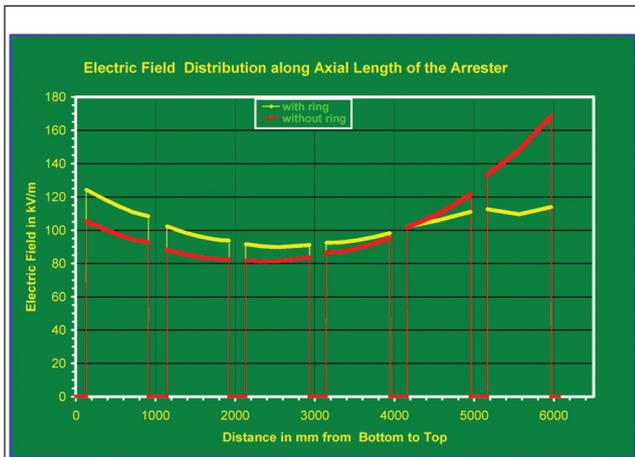
FIG. 4 COMPUTED VOLTAGE DISTRIBUTION ALONG THE AXIAL LENGTH OF THE 624 kV ARRESTER
