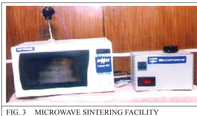
FIG. 3 MICROWAVE SINTERING FACILITY
