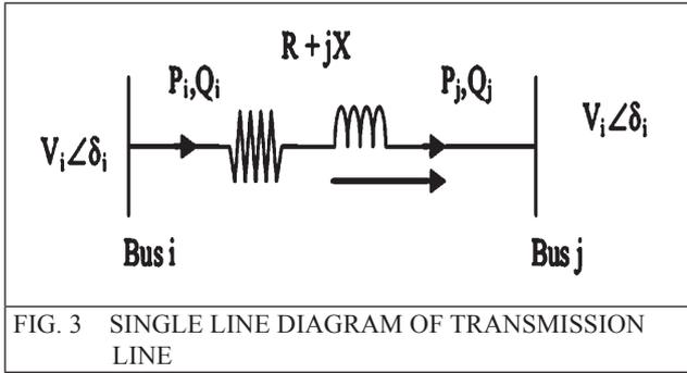
FIG. 3 SINGLE LINE DIAGRAM OF TRANSMISSION LINE
