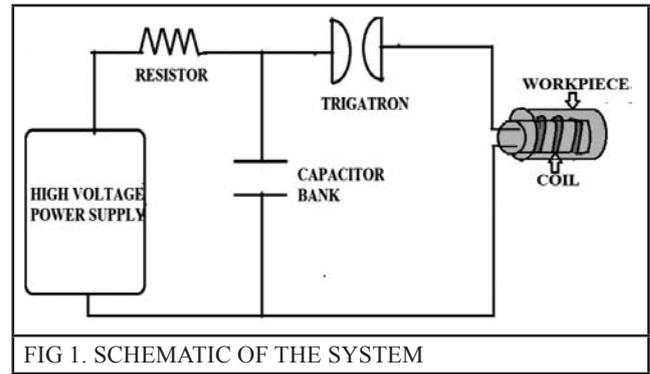
FIG 1. SCHEMATIC OF THE SYSTEM
