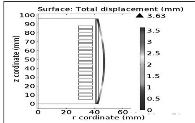
FIG. 6. TUBE DEFORMATION UNDER MAGNETIC PRESSURE AT 2.45 KJ
