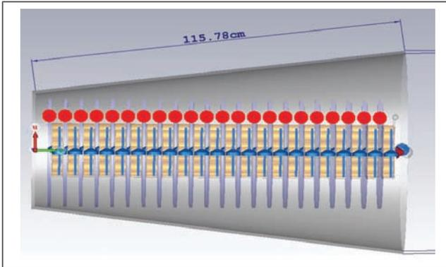
FIG. 5. MARX GENERATOR ON CST MICROWAVE STUDIO WITH CONICAL ENCLOSURE (A = 12CM).
