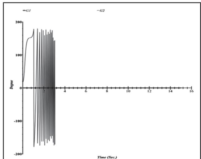
FIG.7. SYSTEM RESPONSE OF THE 9-BUS SYSTEM WITH WIND POWER: RELATIVE POWER ANGLE OF G1 AND G2 FOR THE SYSTEM WITH FCT=0.208S.
