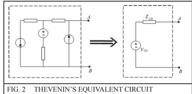
FIG. 2 THEVENIN'S EQUIVALENT CIRCUIT
